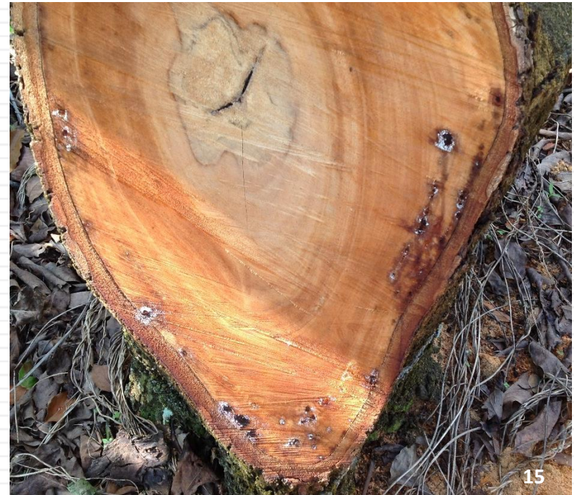
Perforaciones en la albura y manchado de la madera
